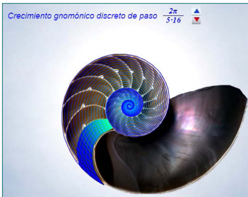
Fig. 21. Aproximación de las cámaras con hexágonos de paso \frac{2\pi}{5 \cdot 16} apoyándose en familias de espirales cordobesas. Comparativa.
