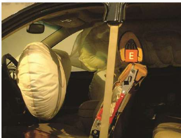
Figura 4.12. Las bolsas de aire se despliegan al impactar para minimizar las lesiones graves a los pasajeros. (Crédito: Jon Seidman)
