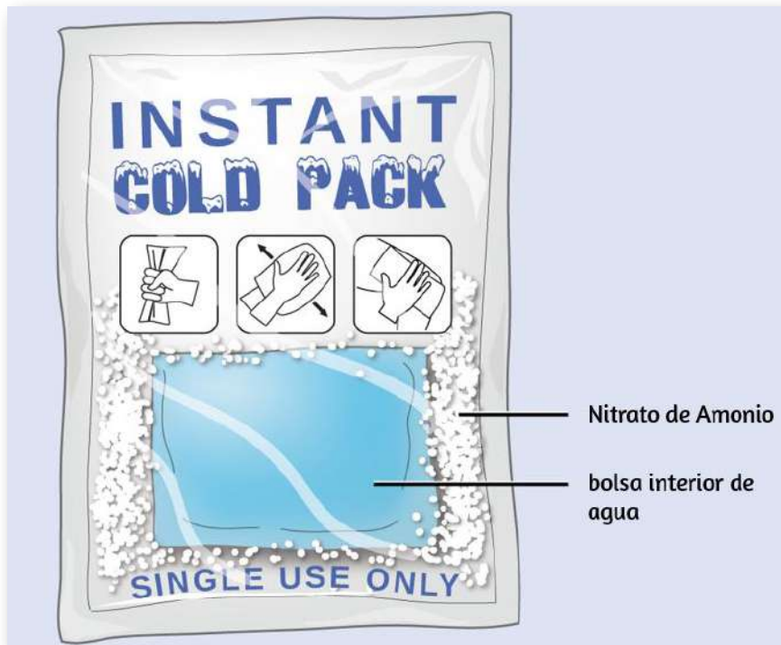
Figura 5.16. Una compresa fría instantánea consiste en una bolsa que contiene nitrato de amonio sólido y una segunda bolsa de agua. Cuando la bolsa de agua se rompe, el paquete se enfría porque la disolución del nitrato de amonio es un proceso endotérmico que elimina la energía térmica del agua. La compresa fría luego elimina la energía térmica de su cuerpo.
