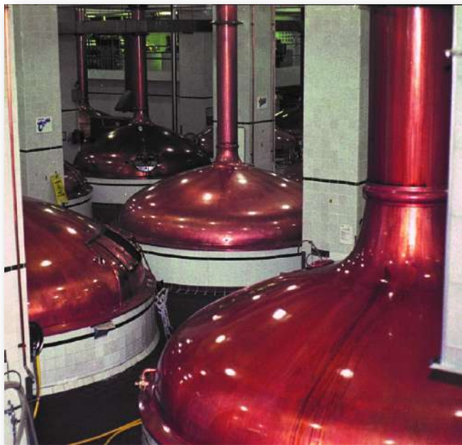
Figura 3.13. Un óxido de carbono se elimina de estos tanques de fermentación a través de los grandes tubos de cobre en la parte superior.(credit: "Dual Freq"/Wikimedia Commons)
