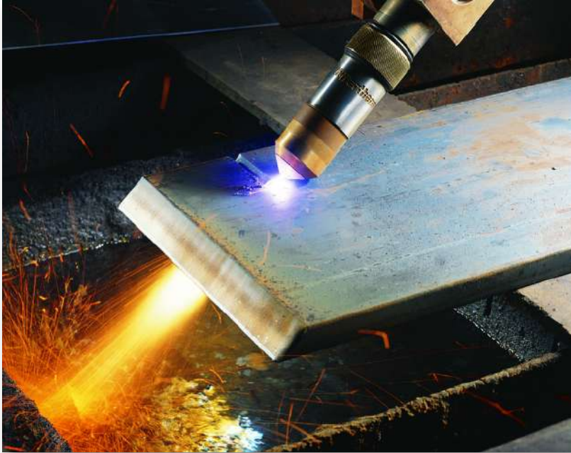
Figura 1.7. Se puede usar una antorcha de plasma para cortar metal (crédito: "Hypertherm"/Wikimedia Commons).
