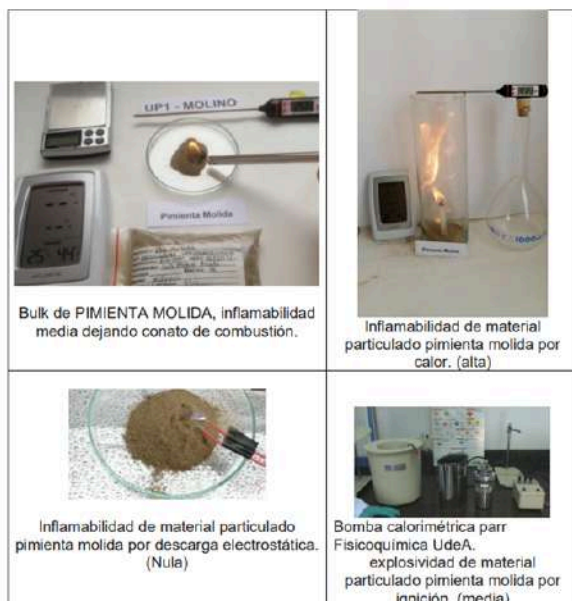
Figura 27 Evidencias experimentales del grado de combustibilidad de las muestras
