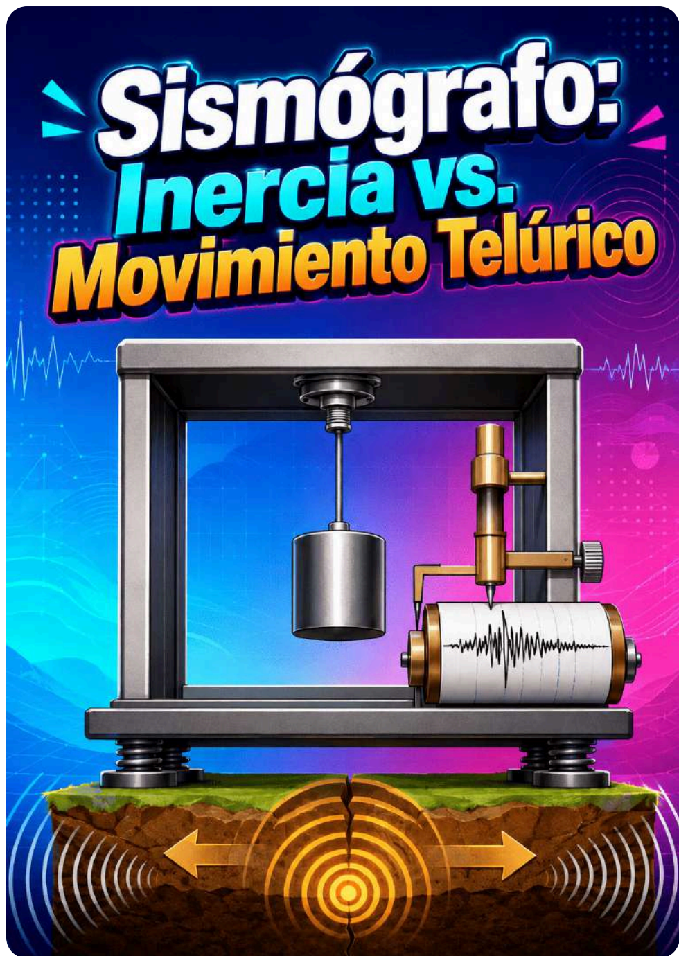
Figura 16. Inercia versus movimiento telúrico.
