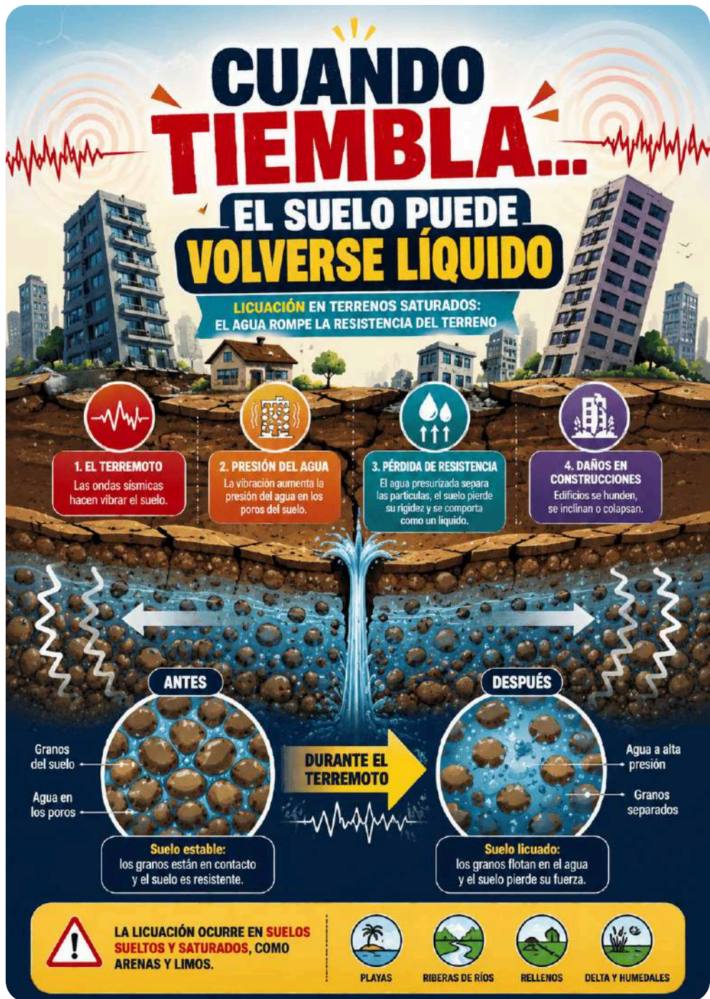
Figura 19. Cuando tiembla el suelo puede volverse líquido.
