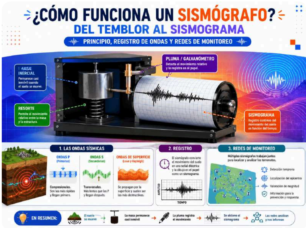
Figura 15. Así funciona un sismógrafo.
