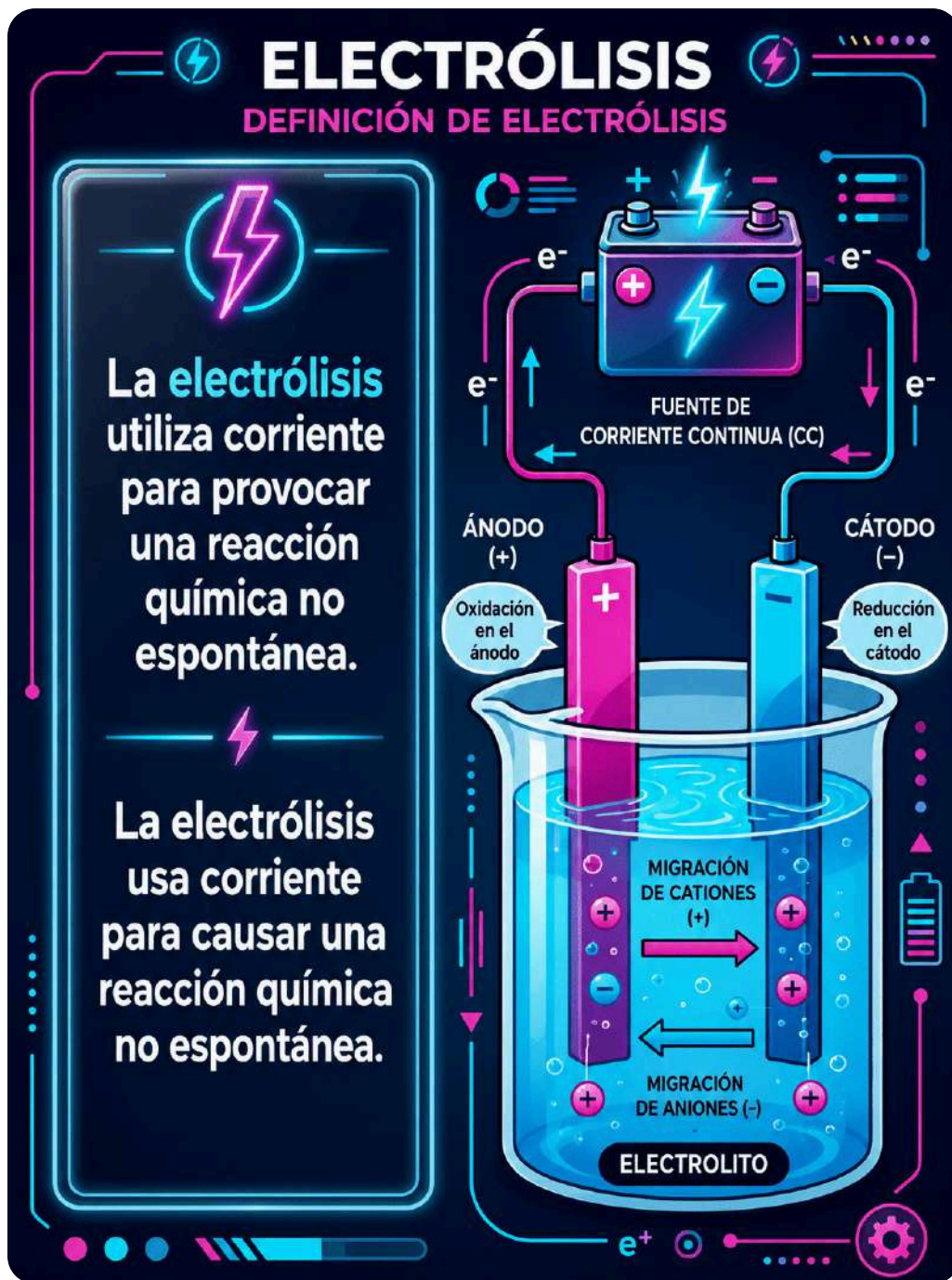
Figura 18. Así funciona la electrólisis
