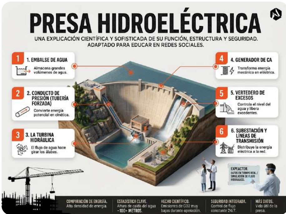
Figura 6. Así funciona una presa hidroeléctrica.
