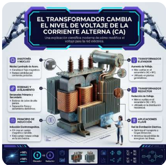
Figura 29. El transformador cambia el nivel de voltaje.
