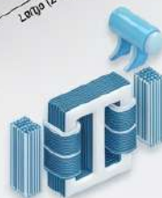
Vista explosión del núcleo y devanados
