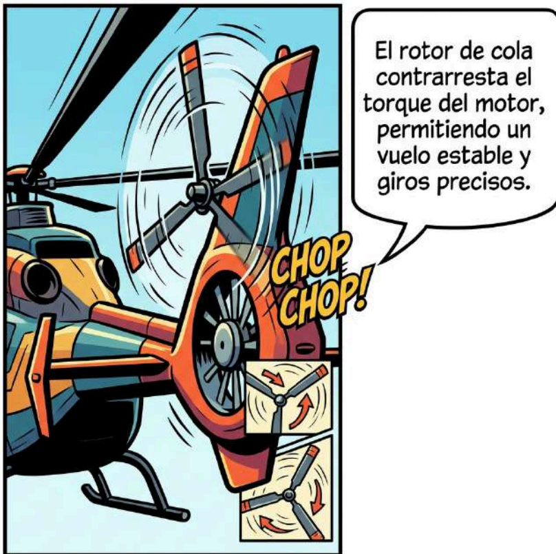
Figura 13. El rotor de cola
