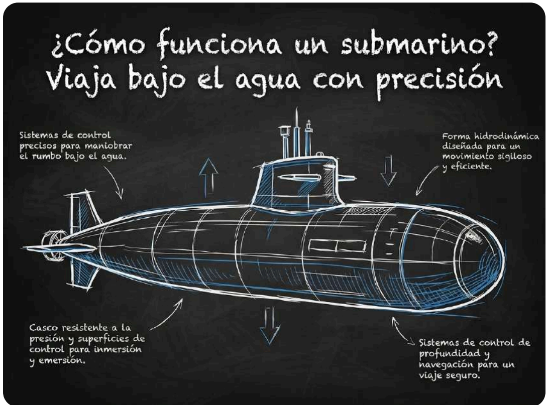
Figura 16. Así funciona un submarino.
