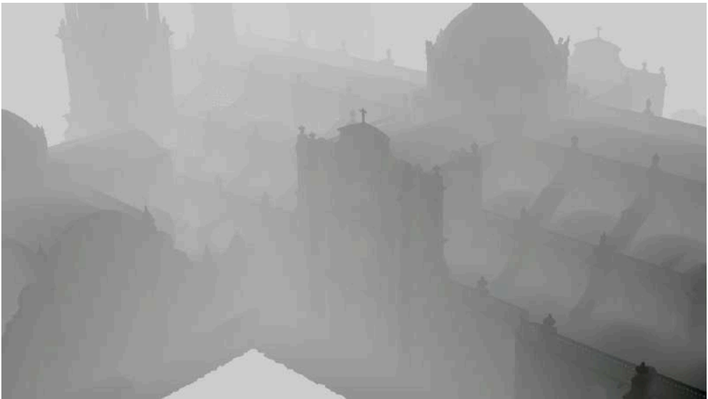
Figura 2.13. En la parte superior de la imagen se puede ver el render final de la catedral. Mientras que en la parte inferior se muestra el búfer de profundidad, el cual se presenta en escala de grises ya que indica la distancia entre la cámara y los objetos representados; los objetos cercanos aparecen en tonos oscuros, mientras que los objetos lejanos aparecen en tonos claros.
