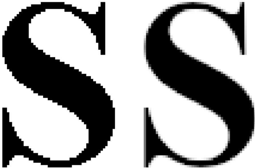
Figura 2.16. Ejemplo de antiescalonamiento ( Antialiasing ) utilizado para dibujar la letra S .
