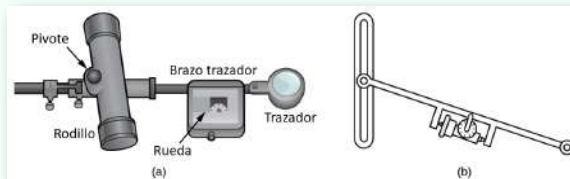
Figura 6.48. a) Un planímetro rodante. El pivote permite que el brazo trazador gire. El rodillo en sí no gira; solo se mueve hacia adelante y hacia atrás. (b) Una vista interior de un planímetro rodante. Observa que la rueda no puede girar si el planímetro se mueve hacia adelante y hacia atrás con el brazo trazador perpendicular al rodillo.
