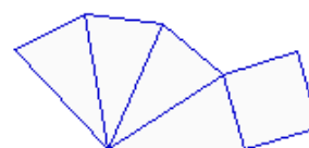
Desenvolvemento dunha pirámide de base cadrada: obtéñense catro triángulos isósceles iguais e un cadrado
