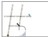
pantógrafo también sirve para hacer ampliaciones, si intercambiamos el lápiz y el punzón. Demuestra que tienes buen pulso y, usando adecuadamente los controles, haz una ampliación al doble del logotipo.
